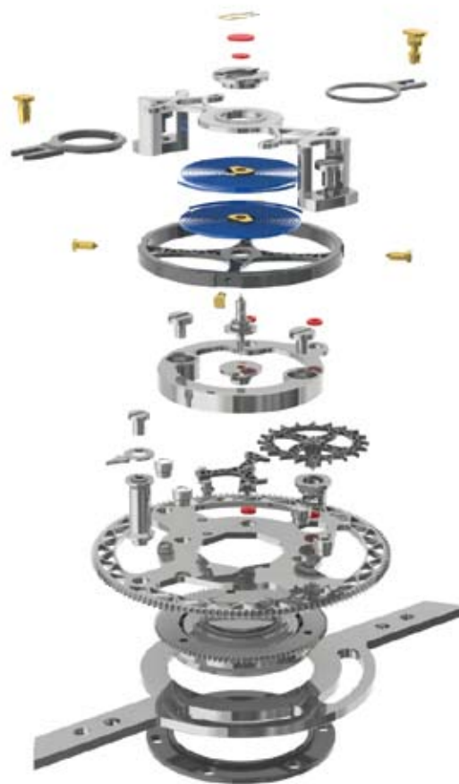
Eclaté de la cage du Tourbillon à double spiral Echappement en silicium avec revêtement diamant 61 pièces pour un poids total de 0,8 grammes Calibre L.512
